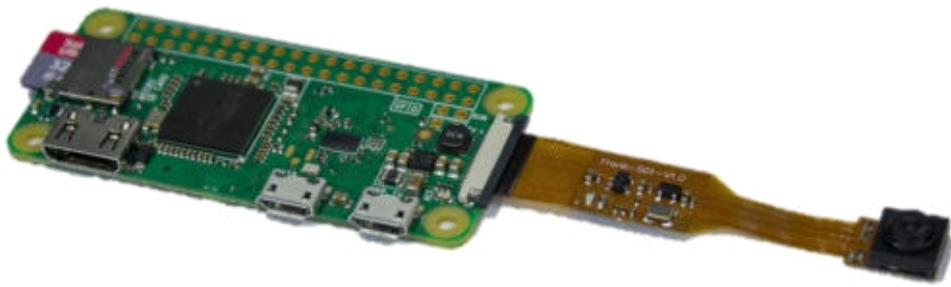
*Abbildung 3, Raspberry Pi Zero mit angeschlossenem Kameramodul.*
