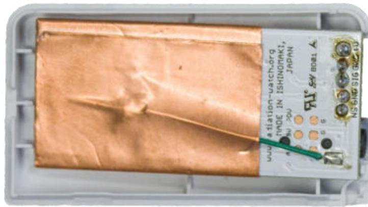
Abbildung 6, Halbleiterdetektor für radioaktive Strahlung.
